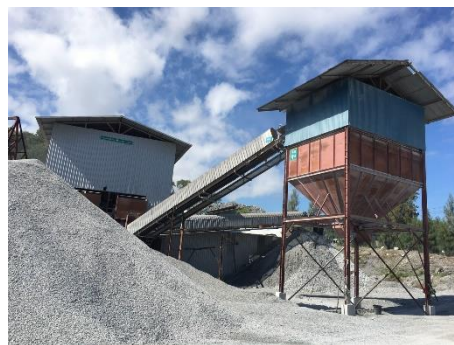
รูปที่ 2-17: การปิดคลุมสายพานลำเลียง
